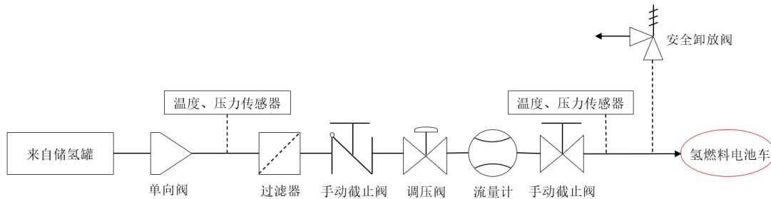
图表 1.12 氢气加注机硬件系统示意图
