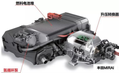
图表 2.5 丰田 Mirai 氢循环泵与电堆位置关系
