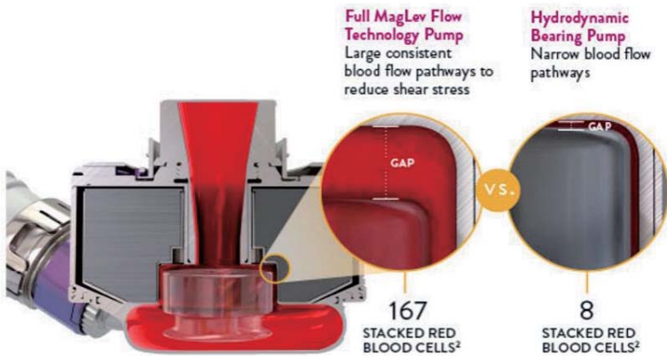
图18：磁液悬浮技术狭小的流道及过高的压力导致其容易产生血栓
