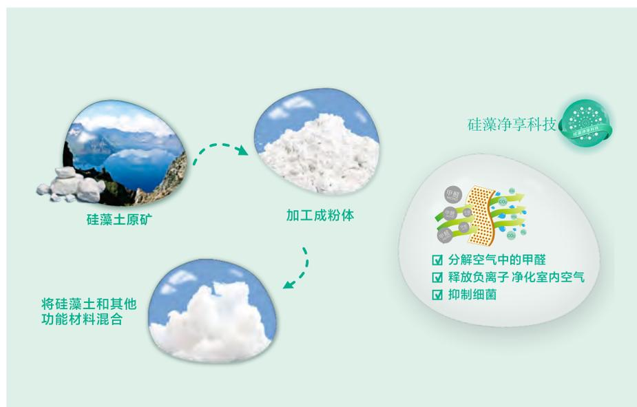
硅藻净享科技就是通过特殊的工艺将硅藻土等功能粉体加入到纤维里边，制得的纤维可以捕获室内的甲醛并将其分解掉，并可释放负离子净化微环境，同时还具备良好的抗菌抑菌能力。
