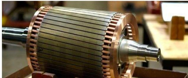
图 7. 交流异步电机转子结构
